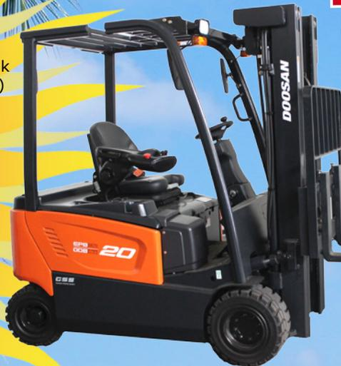
Spannung / max. Kapazität 48 V / 770 Ah
