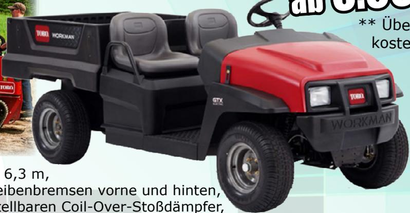
Kohler-Einzyylinder-Benzinmotor, Wendekreis: 6,3 m, Innenwendekreis: 153 cm, Hydraulische Scheibenbremsen vorne und hinten, modifiziertes MacPherson-Federbein mit einstellbaren Coil-Over-Stoßdämpfer, 25,6 km/h, 2 Sitze, Beleuchtungsanlage nach StVZO, Breite: 1,2 m, Länge: 3 m, Gewicht: 397 kg, Ladepritsche: 97,8 x 101,6 cm, Nutzlast: 544 kg
